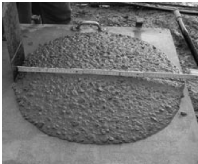
Bild 2: Auf der Baustelle wird u.a. die Frischbetonkonsistenz geprüft (hier: F4/F5)
